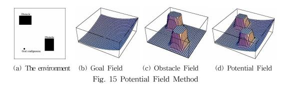
일반적으로 포텐셜 필드 방법은 목표점에 의한 인력에 의해 발생하는 부분  $U_{goal}(q)$ 과 장애물에 의한 척력에 의해 발생하는 부분  $U_{obs}(q)$ 으로 구분되며,
