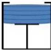
이와 같은 스택은 가장 나중에 들어간 데이터가 가장 먼저 지워지기 때문에 후입선출(LIFO: Last-In First-Out)구조라고도 합니다. 스택은 배열을 이용하거나 연결리스트를 이용해서 구현할 수 있는데 간단히 배열로 구성된 스택을 살펴보면 다음과 같습니다.
