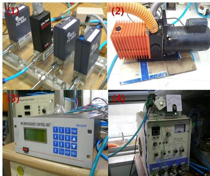
[그림 30] (1) Aera FC-980 MFC, (2) Alcatel 2012A 펌프, (3) FM-30VP MFC-Control Unit, (4) MICRO 350X 전원공급장치
