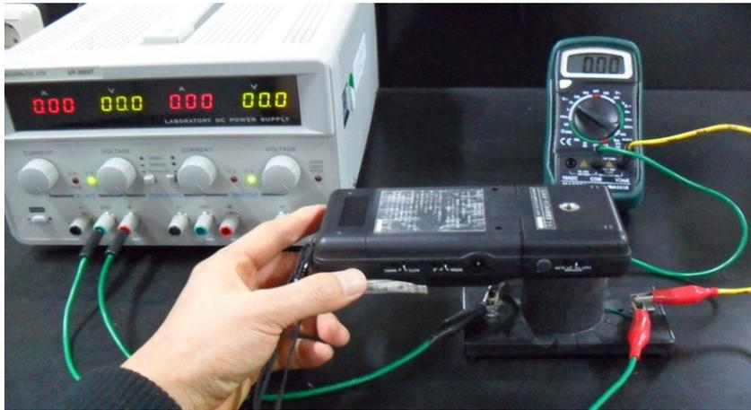
[사진 II-3] 전구에 인가된 전압에 따른 전구의 밝기를 측정하기 위한 실험
