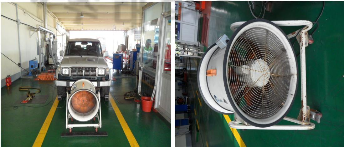
Photo. 2.8 Engine cooling blow fan
