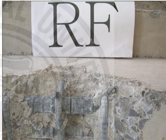
(d) Rupture of reinforcing bar
